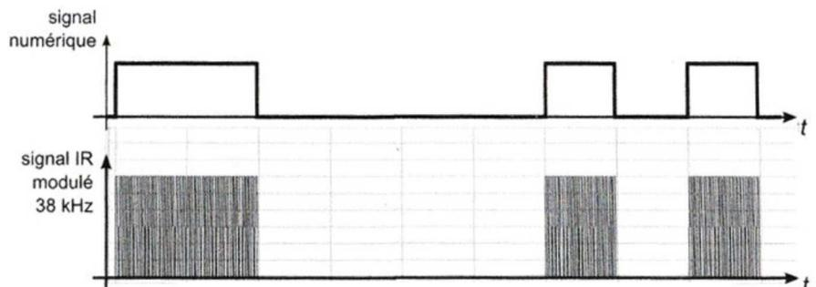
Figure 2 : Modulation du signal infrarouge
